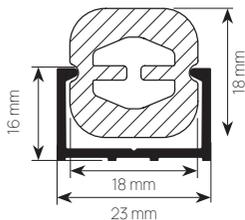
Perfil difusor en silicona de alta calidad, diseñado para insertar la tira de LED en su interior y aplicarlo superficialmente con perfil de sujeción o disipante de calor sin necesidad de fresado. Completamente sumergible bajo sellado profesional.
